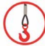
Работа при отсутствии защелки на крюках
